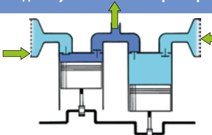
Одноступенчатый компрессор имеет один или несколько цилиндров, каждый из которых сжимает воздух от атмосферного давления до рабочего.
