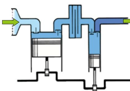
Многоступенчатый компрессор имеет один или несколько последовательно подключенных цилиндров, в которых воздух последовательно сжимается до конечного давления. Между ступенями сжимаемый воздух охлаждается наружным воздухом. Поэтому увеличивается эффективность (КПД) с достижением гораздо большего давления, чем в одноступенчатом компрессоре.
